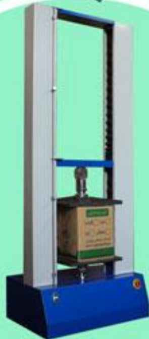
تست فشار کارتن BCT
