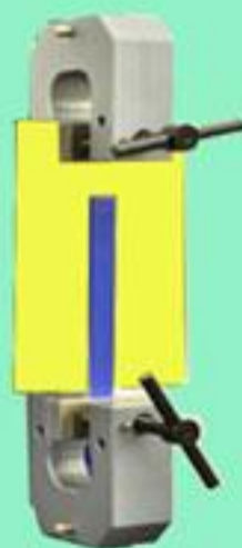
تست پیل (چسبندگی) Peel
